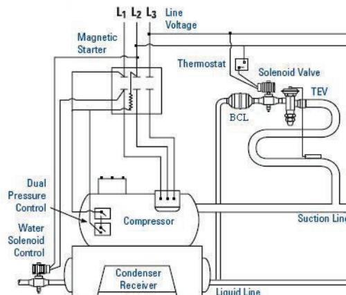
СВ закрывается по сигналу от термостата, после чего компрессор работает, откачивая остаточное количество хладагента из испарителя. Для отключения компрессора используется реле низкого давления. При повышении температуры термостат подает сигнал на открытие СВ, что в свою очередь повышает давление в испарителе и компрессор включается.
