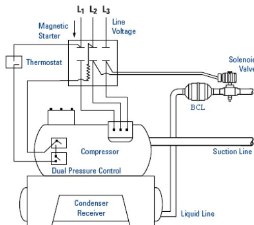
Другая разновидность применения СВ- это работа установки по циклу откачки после закрытия СВ. Для отключения СВ в этом случае используют термостат. Данный тип применения изображен ниже.
