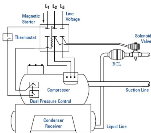
Другая разновидность применения СВ- это работа установки по циклу откачки после закрытия СВ. Для отключения СВ в этом случае используют термостат. Данный тип применения изображен ниже.
