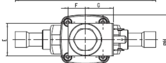
Соленоидные вентили серии BC-EMV (IT), нормально закрытые, предназначены для установки в жидкостные и всасывающие линии, а также трубопроводы горячего газа холодильных установок и систем кондиционирования воздуха, работающих на всех хладагентах за исключением CO<sub>2</sub> и NH<sub>3</sub>.
